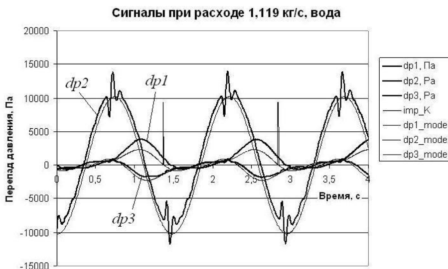
Рис. 3. Вид сигналов ИР при измерении на воде, расход 1,119 кг/с. Эксперименты проведены согласно схеме на рис. 1
