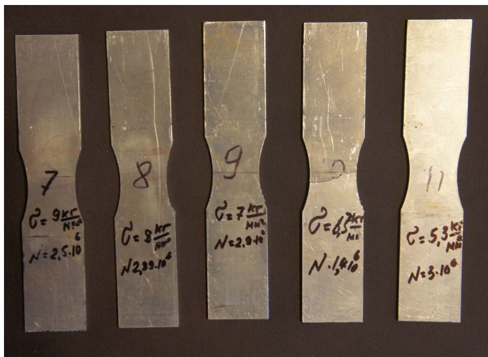
Рис. 2. Образцы, изготовленные лазерным раскроем, после испытаний на усталость
