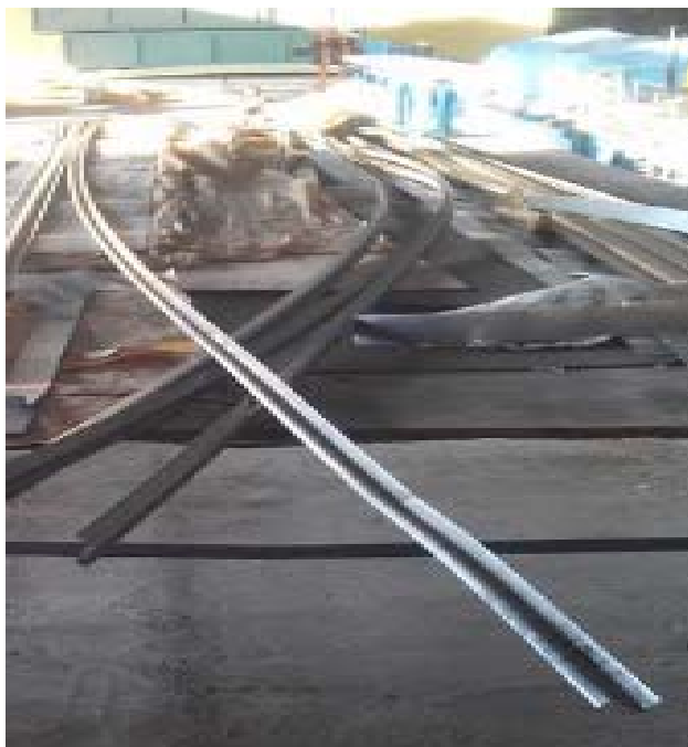
Рис. 1 Тонкостенные профили из алюминиевых сплавов с различными видами дефектов
