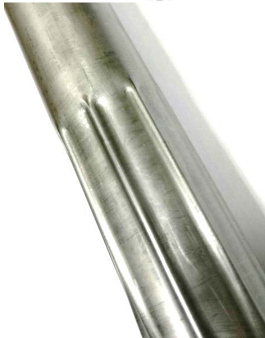
Рис. 9. Прогиб части гофров вовнутрь
