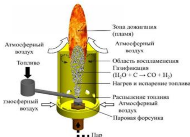
РИСУНОК 1. Схема атмосферного горелочного устройства с распылением жидкого топлива струей перегретого водяного пара с естественным притоком воздуха
