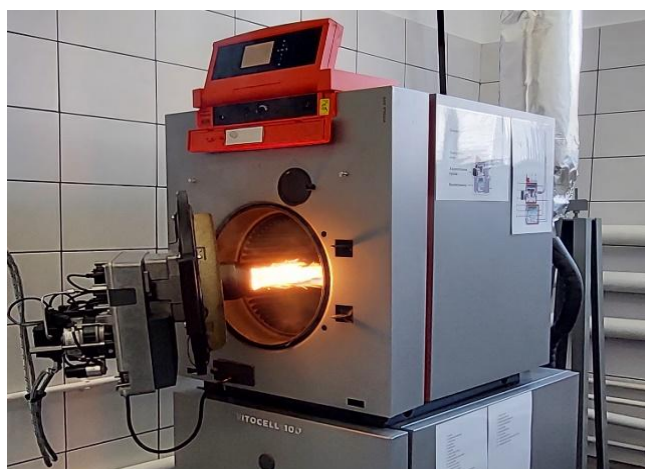
РИСУНОК 4. Опытная установка для испытания жидкотопливных горелочных устройств на базе водогрейного котла Viessmann
