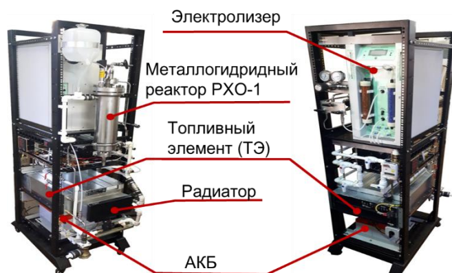
РИСУНОК 1. Экспериментальная энергоустановка «H 2 Smart» ЛВЭТ ОИВТ РАН [12].
