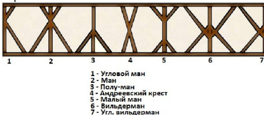
Рисунок 3. Комбинация вертикальных, горизонтальных и диагональных элементов в каркасе[2]
