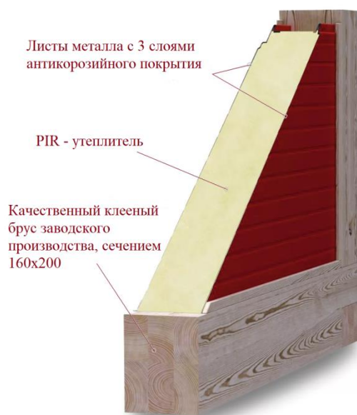
Рисунок 5. Схема PIR-утеплителя в конструкции фахверка [3]
