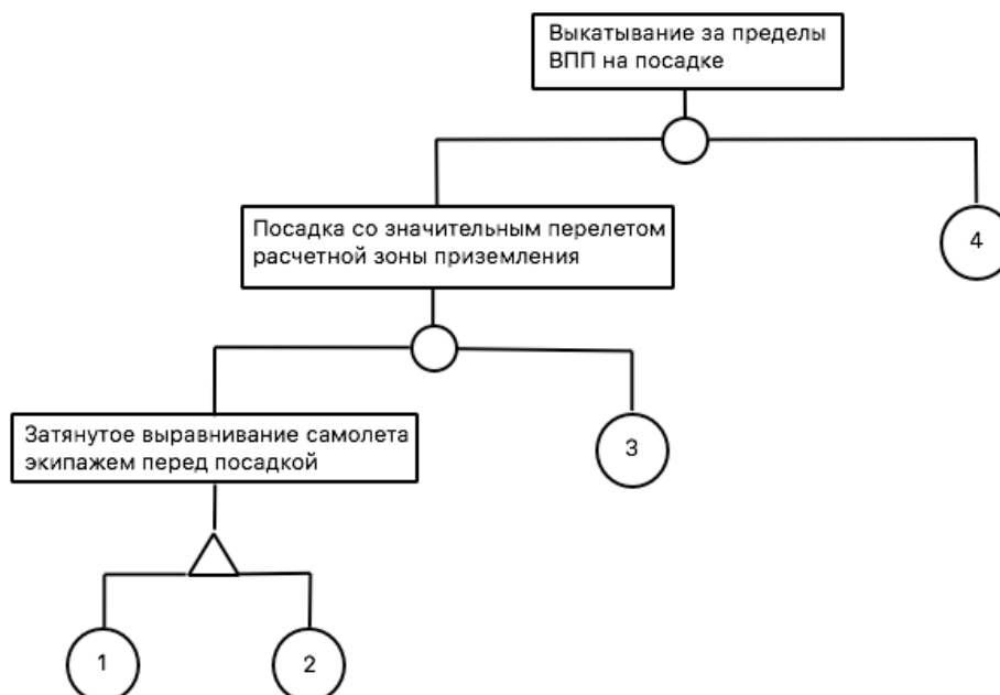
Рис. 1. «Дерево факторов опасности» одного из сценариев выкатывания самолёта за пределы взлётно-посадочной полосы (ВПП)
