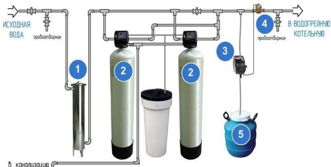
Рис. 1. Водоподготовка для водогрейных котлов: 1 – мешочный фильтр для механической очистки воды; 2 – умягчитель-обезжелезиватель непрерывного действия; 3 – насос-дозатор реагента обработки воды; 4 – импульсный расходомер обработанной воды; 5 – реагент комплексной обработки воды
