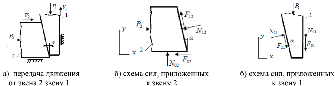
Рис. 3. Схема передачи движения от звена 2 к звену 1 в клиновом механизме
