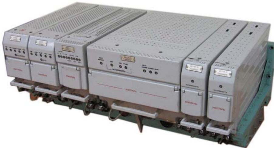
Рис. 3. БЦВМ «Орбита-20» образца 1969 года, производства АО «ОКБ «Электроавтоматика»
