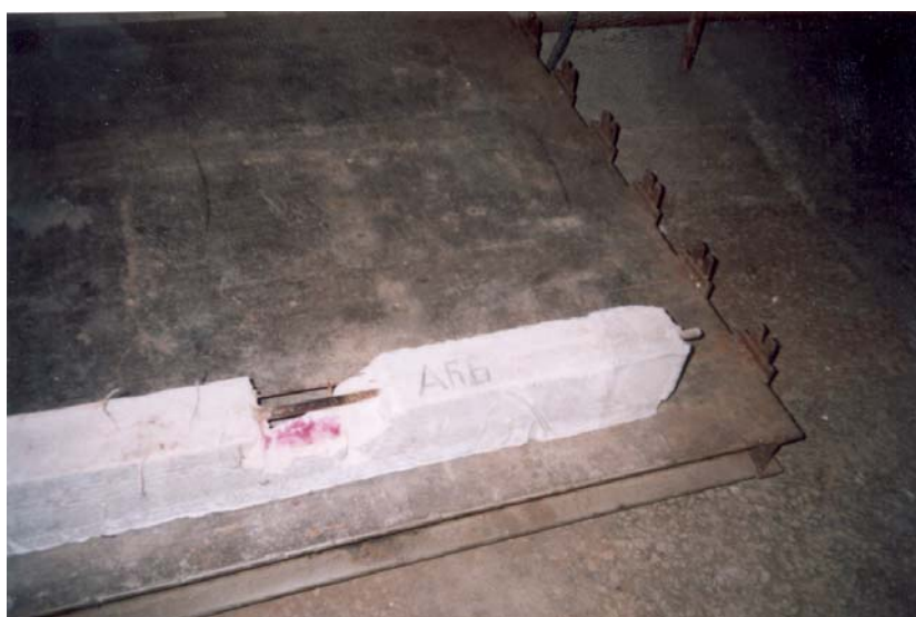
Рисунок 1 – Сохранность преднапряженной арматуры в арболите
