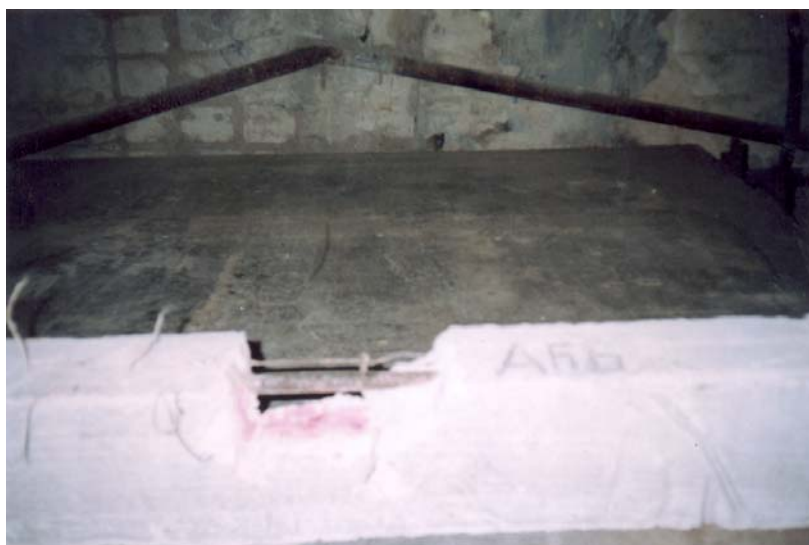
Рисунок 2 – Глубина карбонизации в арболите
