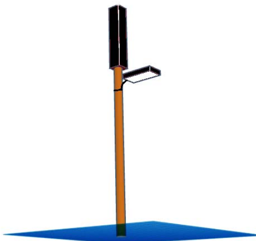
Рис 2. Общий вид автономного светильника с «кубическим» расположением панелей
