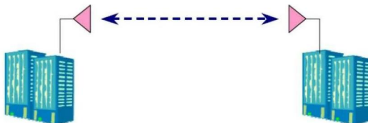
Рис. 4. Организация сетевого обмена при помощи соединения «точка-точка» [9]
