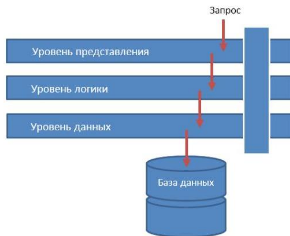
Рис. 3. Принцип работы многоуровневой архитектуры [8]
