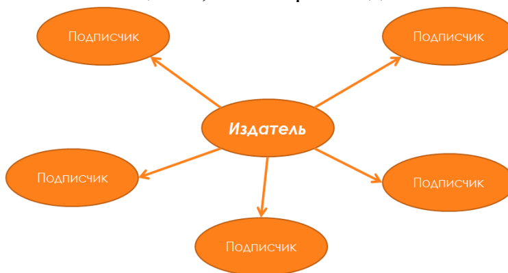
Рис. 6. Принцип работы технологии «издатель-подписчик»
