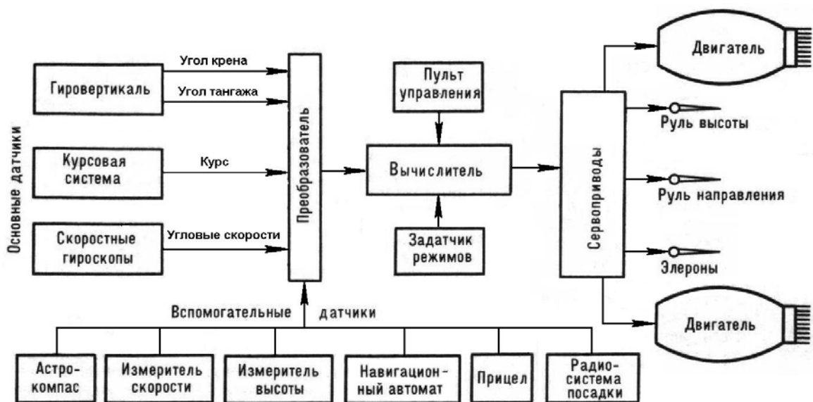
Рис. 7.9. Структурная схема автопилота
