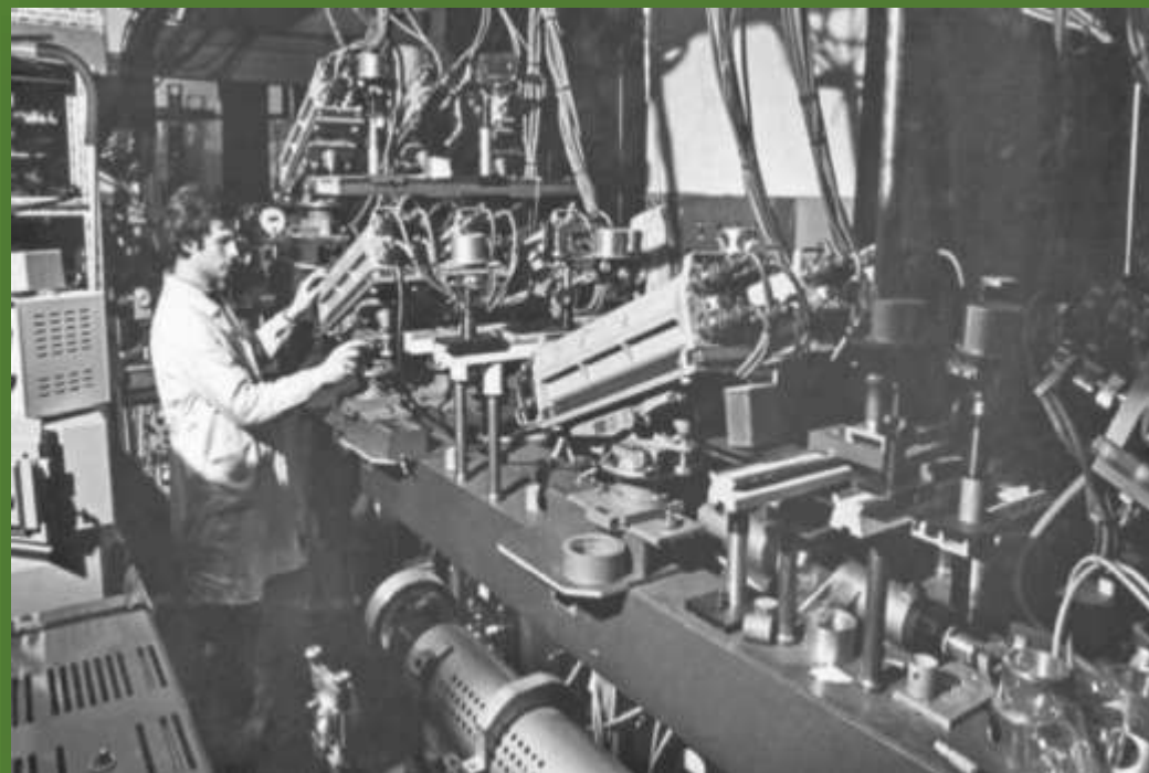
Лазер «Кальмар» — первая в мире многоканальная установка для сферического облучения термоядерных мишеней. Была создана в начале 70-х под руководством Басова.
